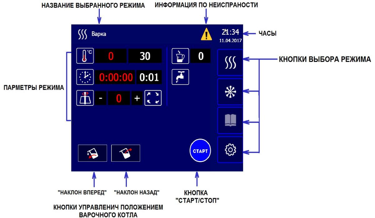
Если на панели управления котла оператор более одной минуты не нажимает на кнопку, то сенсор экрана автоматически блокируется. О чем свидетельствует информационный символ на экране в виде символа «закрытый замок».
