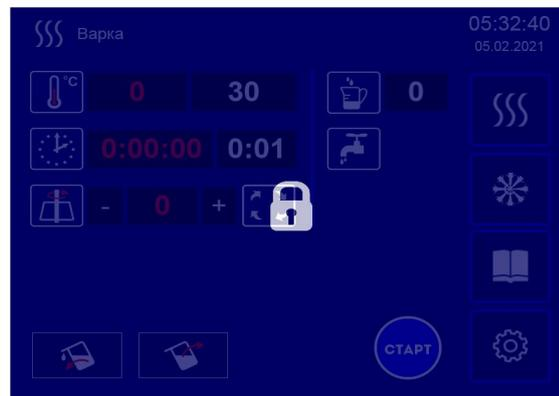
Для разблокировки сенсора экрана нажмите на символ «закрытый замок». После нажатия на символ «закрытый замок» справа от знака должен появиться символ «открытый замок».
