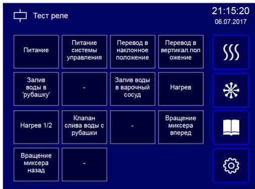
Экран, с которого возможно ручное управление релейными выходами.
