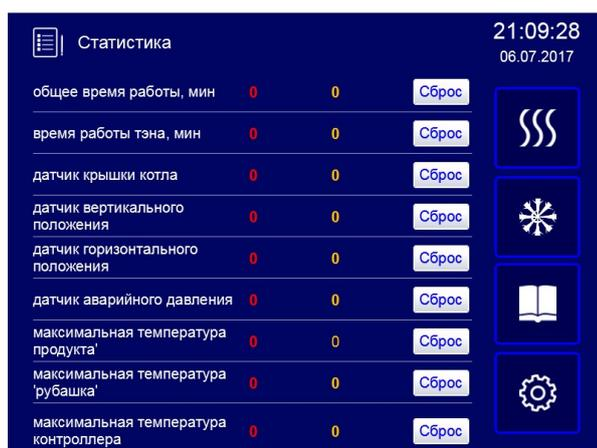
Экран, где возможно посмотреть данные о наработке узлов (время и количество циклов работы), данные полученные от датчиков температуры. Так же данный экран предназначен для сервисных инженеров для контроля времени работы узла(ов) после их замены. Имеется сбросить (обнулить) часть данных, которые имеют желтый цвет. Данные с красным цветом не могут быть обнулены.
