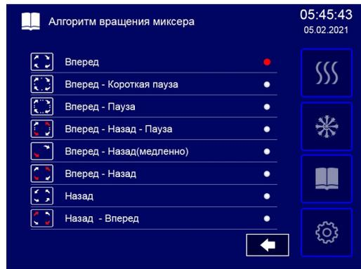
Для изменения алгоритма перемешивания нажмите и отпустите на кнопку с символом «Перемешивания». При этом информационная точка с ранее выбранного алгоритма перемешивания должен перейти на текущий выбранный алгоритм перемешивания. Визуально проконтролировать изменение алгоритма работы мешалки.
