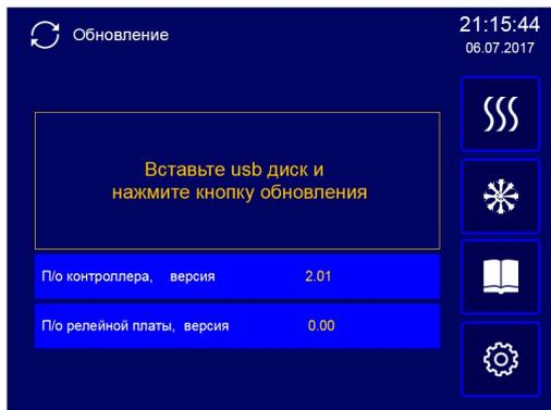
Экран, для визуального контроля версии программного обеспечения, а так же для обновления программного обеспечения релейной платы и основного контроллера (компьютера).
