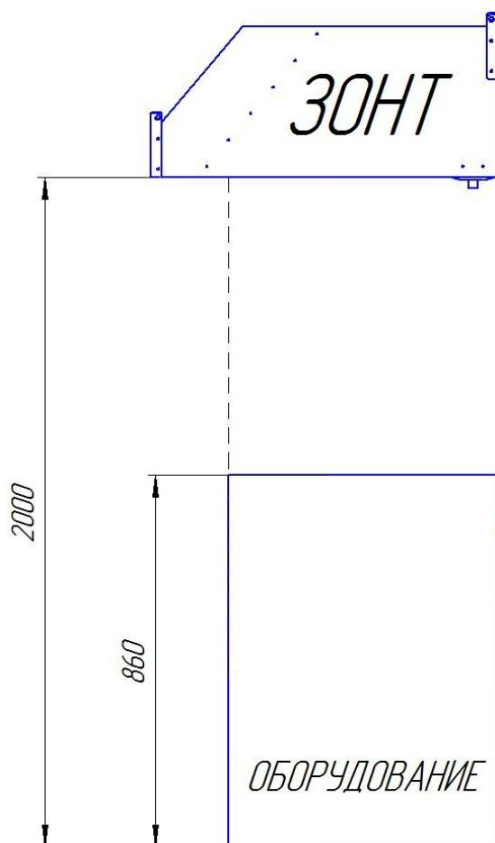
3. Прикрепить патрубок и воздуховод имеющейся аспирационной системы. Установить фильтра. Установить на место пластиковый отвод. После установки зонта проверить тягу вытяжного вентилятора листом бумаги.
