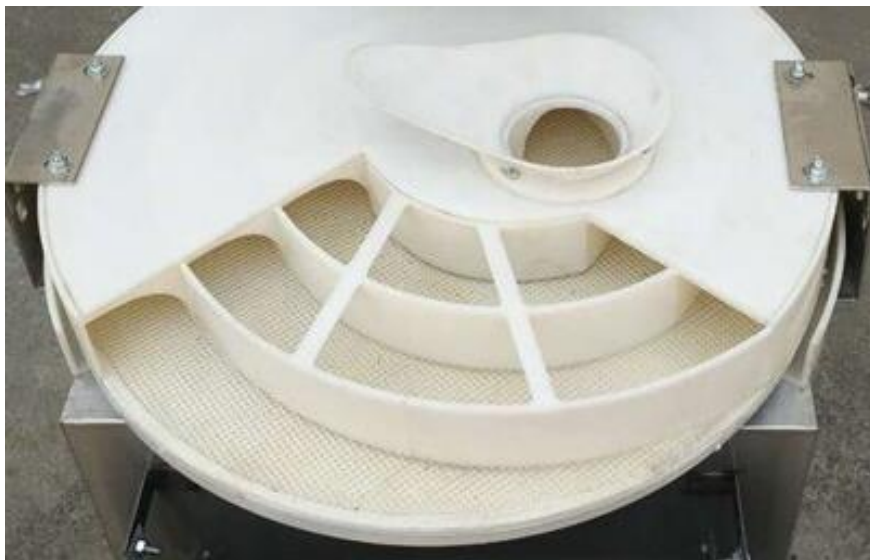
Рис 1. Диск вращения, формирование процесса округления тестовой заготовки.
