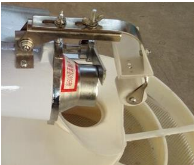
Рис 2. Регулировочные винты отрезного механизма.
