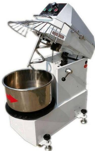
4. Для остановки работы нажмите кнопку «STOP», отключите питание, проверните рукоятку для поднятия верхней части машины и достаньте тесто. Для вынимания чаши поверните ее по почасовой стрелке до полной разблокировки.
