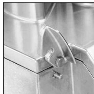
6) Вставьте стержень шарнира в предусмотренное для него место, расположенное сзади блока. Заблокируйте затем крышку на блоке двигателя с помощью крепежной лапки. Ваш аппарат теперь готов к работе. **Для моделей R 502 и R 602** для функции овощерезки предусмотрена только одна скорость (750 об/мин). Селектор скорости не действует. **Для моделей R 502 V.V. и R 602 V.V.** диапазон скоростей, предусмотренных для функции куттура, регулируется автоматически и колеблется от 300 до 1000 об/мин.
