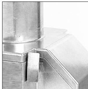
1) Поставьте блок двигателя перед собой, правой рукой разблокируйте алюминиевую крепежную лапку, служащую для блокировки головки овощерезки на блоке двигателя.
